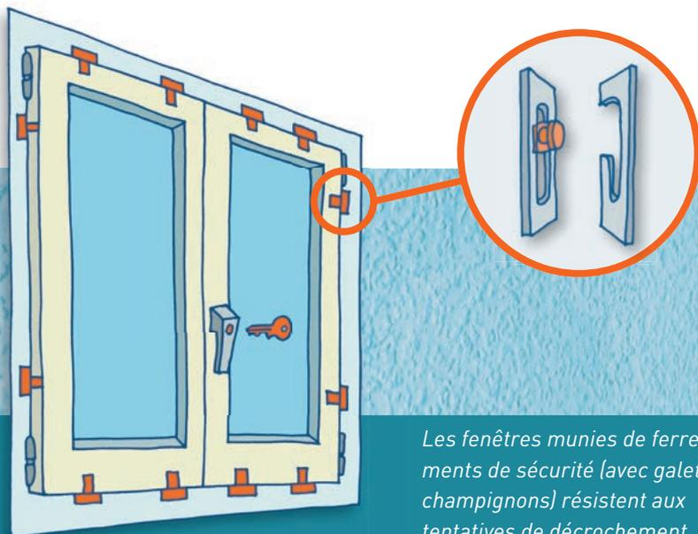
*Les fenêtres munies de ferrements de sécurité (avec galets champignons) résistent aux tentatives de décrochement.*
