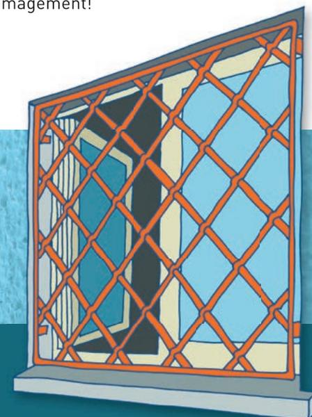
*On empêchera l'écartement des barres de la grille d'une fenêtre en l'équipant de renforts transversaux.*
